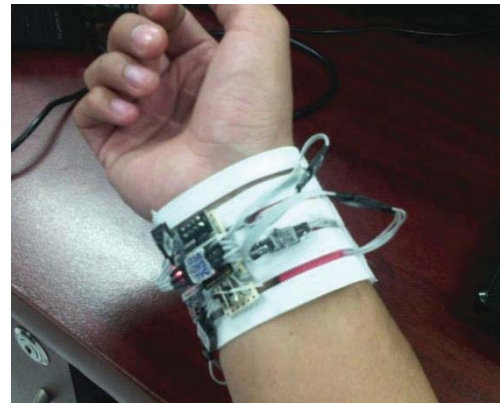
Fig. 14. Colocación de la pulsera para medir la temperatura corporal y la frecuencia del pulso radial en una persona adulta.
