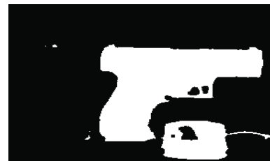
Figura 8. Imagen dilatada y erosionada.
