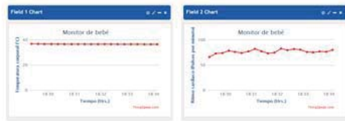
Fig. 18. Prueba 4 en ThingSpeak, utilizando la pulsera para medir la temperatura corporal y la frecuencia del pulso radial.
