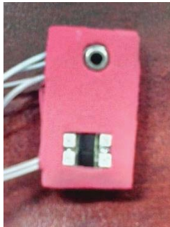
Fig. 5. Diseño final de la placa para el sensor de pulso y temperatura.
