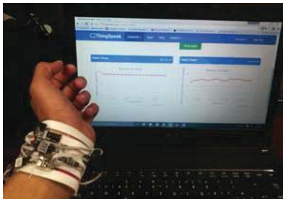
Fig. 19. Implementación del prototipo final para medir la temperatura corporal y la frecuencia del pulso radial.
