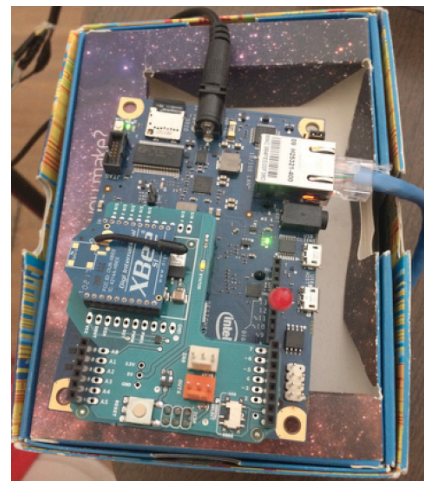
Fig. 4. Receptor Galileo. Véase la interfaz ethernet que reenvía las mediciones a un servidor remoto.
