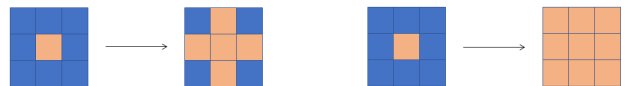
Fig. 3 Diferencia entre una transición utilizando un vecindario de Von Neumann (izquierda) y utilizando un vecindario de Moore (Derecha).
