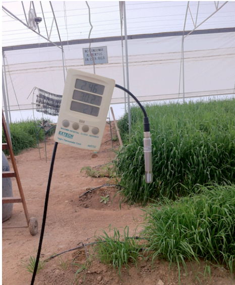
Fig. 2. Calibración de sonda Vaisala con respecto al termómetro que tienen en el Invernadero
