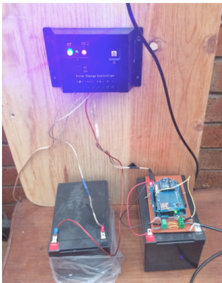
Fig. 3. Emisor. Note un microcontrolador Arduino Uno, alimentado por energía proveniente de una celda solar. Véase el cable que sube, es la sonda Vaisala, que hace la medición de la temperatura.
