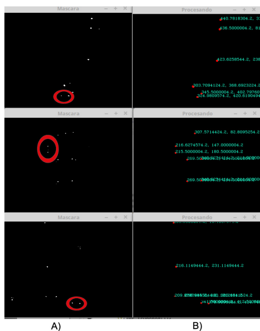
Figura 9. Identificación de marcadores: A) Imagen binaria con la detección del color rojo y señalando los puntos de referencia B) Imagen con los centroides de los marcadores y sus coordenadas 2D.
