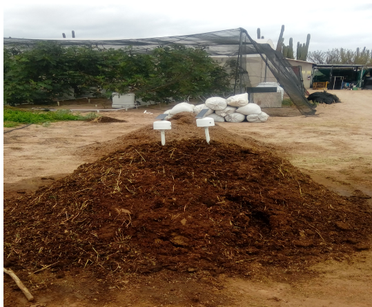
Figura 6. Montículo de composta con dos nodos de sensores en las instalaciones del CIBNOR.
