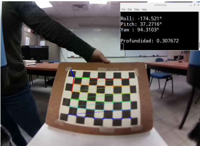
Figura 8. Resultados del algoritmo de visión para detección de postura de un patrón de tablero de ajedrez colocado a una separación de 30cm a la cámara del submarino.
