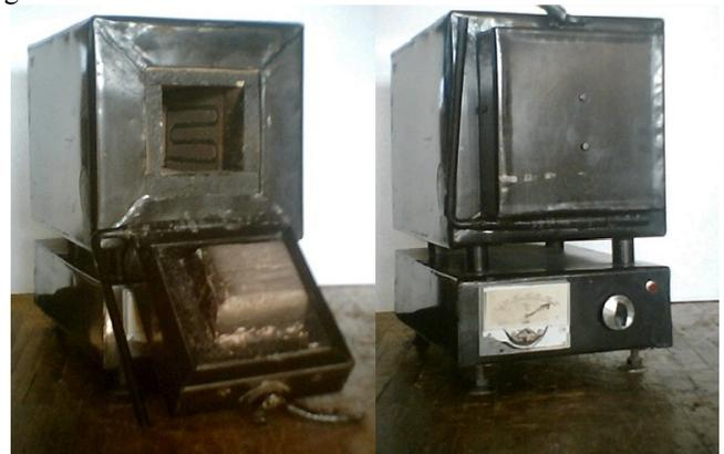
Fig. 2. Fotografías del horno eléctrico abierto y cerrado.
