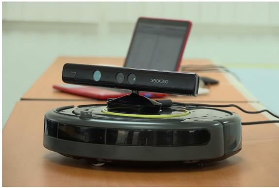
Fig. 5. Robot Create 2, con el sensor Kinect y la computadora de control.
