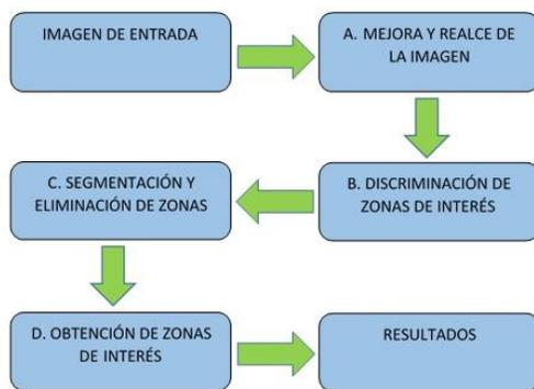
Fig. 2. Estructura de los métodos para detección de baches del banco de algoritmos.
