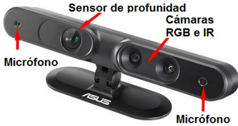
Figura 2. Sensor RGB-D utilizado, cuenta con una cámara RGB, dos micrófonos, un emisor de puntos infrarrojos y un sensor infrarrojo.
