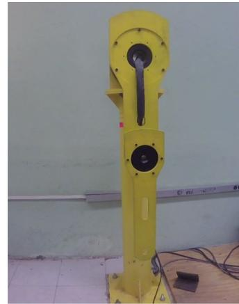
Figura 4: Robot de dos grados de libertad.
