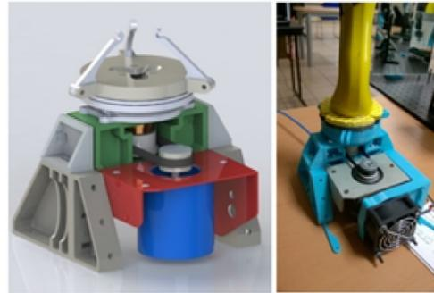
Figura 2 Sistema de base giratoria. Modelo del mecanismo (izquierda) e implementación final (derecha).
