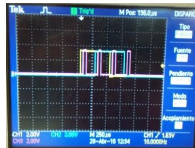
Fig. 13: Señales de encoder y señal retardadora.
