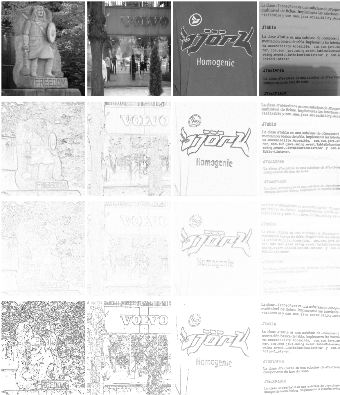
Figura 3.4. Identificación de bordes a través del algoritmo de Canny modificado.
