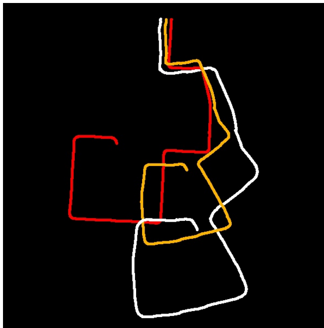
Figura 4.2: Trayectoria real, estimada con escala y sin escala de la primera secuencia del KITTI dataset .
