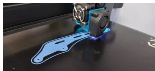
Fig. 5.- Impresión del robot manipulador.
