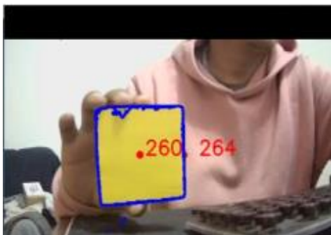
Fig. 17.- Resultado de la búsqueda del color amarillo con la visión artificial.
