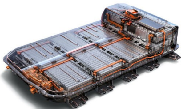
Fig. 6. Conjunto de baterías y sistema de control de temperatura en anaranjado del BMW i3
