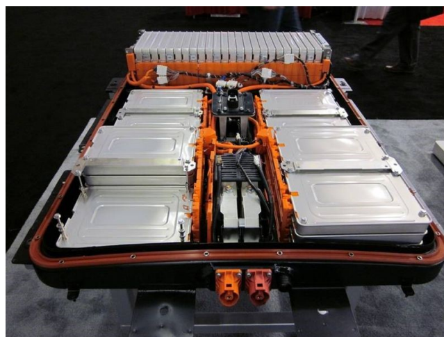
Fig. 5. Conjunto de baterías del coche eléctrico Leaf de Nissan.
