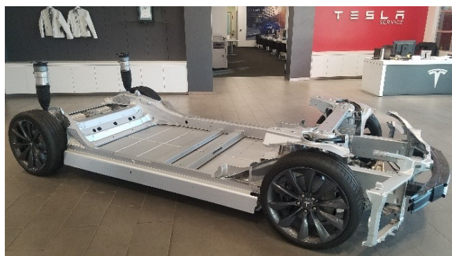
Fig. 3. Chasis de coche Tesla armado con llantas, amortiguadores, sistema mecánico de dirección y baterías.
