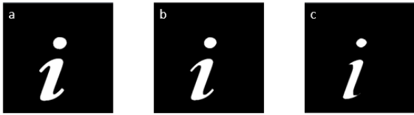
Figura 18. Ejemplo de erosión: a) imagen original, b) con un elemento estructurante de 3x3, y c) con un elemento estructurante de 7x7.
