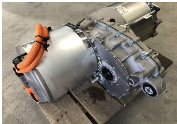
Fig. 2. Fotografía de un motor de un coche Tesla junto con su caja de engranes, sistema de enfriamiento y sensores.
