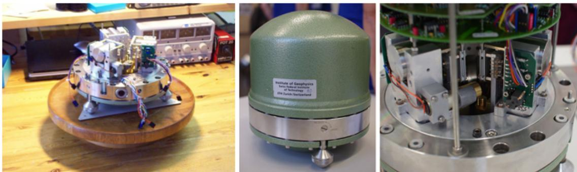
Figura 2.3.2: Sensor STS-2 utilizado en las estaciones IRIS / IDA GSN. Es un sensor triaxial de banda ancha fabricado por G. Streckeisen AG.
